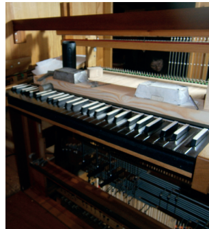
Das Manual ist vormontiert und muss noch justiert werden.
